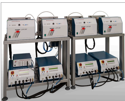
Geräteinheit für bis zu vier Schweißköpfe Welding equipment for up to four welding heads
